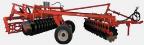
**Браните се предлагат като опция с дискове Ф610 и оси кв.40****Снимката е примерна!****Технически характеристики**
