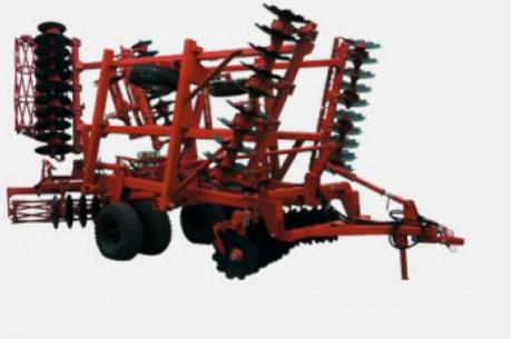
**Браните се предлагат като опция с дискове Ф610 и оси кв.40****Снимката е примерна!****Технически характеристики**
